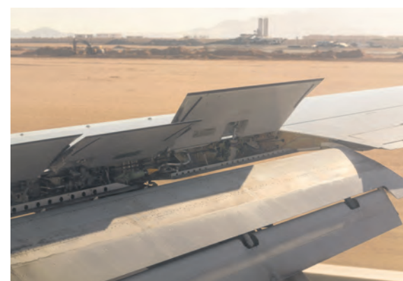
Contoh panel lift dump spoiler pada sayap pesawat model lain
